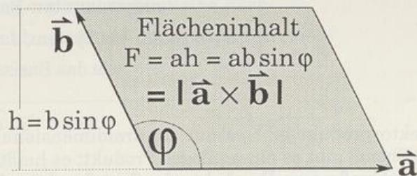
Die Länge von  $\vec{a} \times \vec{b}$  ist gleich dem Flächeninhalt des von  $\vec{a}$  und  $\vec{b}$  aufgespannten Parallelogramms. Das ist eine anschauliche Erklärung dafür, daß das Kreuzprodukt paralleler Vektoren den Nullvektor ergibt; das zugehörige, zu einer Strecke entartete Parallelogramm hat den Flächeninhalt 0.
