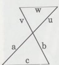
Ein einfaches Verfahren zur Schätzung von Entfernungen beruht auf dem »Daumensprung«. Die Strahlensätze an der X-Figur erklären, wie es funktioniert.
