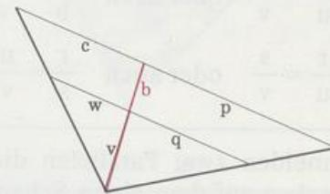
*in Wörtern:* Werden Strahlen mit gemeinsamem Anfangspunkt von zwei Parallelen geschnitten, so verhalten sich die parallelen Strecken der einen V-Figur wie die parallelen Strecken der andern V-Figur.
