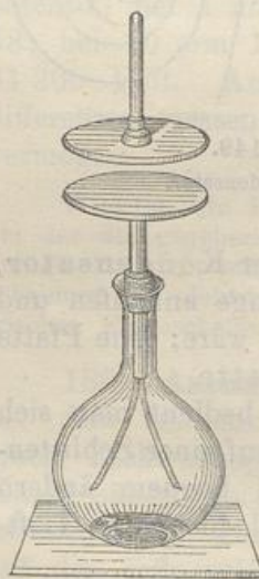
Fig. 150. Goldblattelektroskop mit Kondensator.
