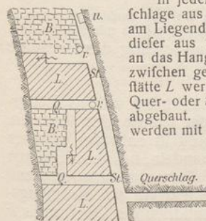
Fig. 1 (Grundriß). ---→ Richtung des Betriebes. L Lagerstätte. St Streichstrecke. Q Querschläge. u Wetterüber- hauen. r Rollen. B Bergeveratz. M Bergemühle.
