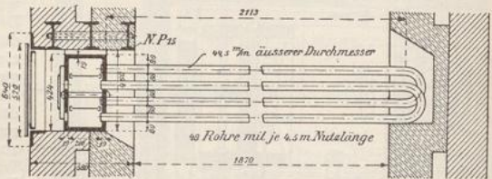
Fig. 17. Ueberhitzer der Düffeldorf-Rätiger Röhrenkesselfabrik, vorm. Dürr &amp; Co.
