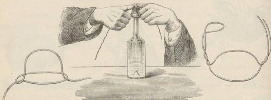
Fig. 180. Verbinden von Korkstöpseln.
