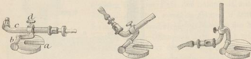
Fig. 84—86. Bunsenbrenner von DIERBACH.
