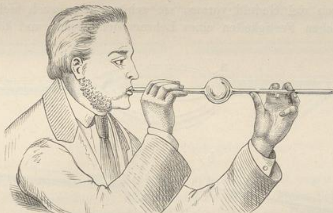
Fig. 142. Kugelblasen in der Mitte.
