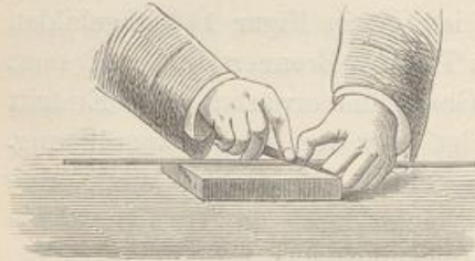
Fig. 115. Schneiden von Glasröhren.
