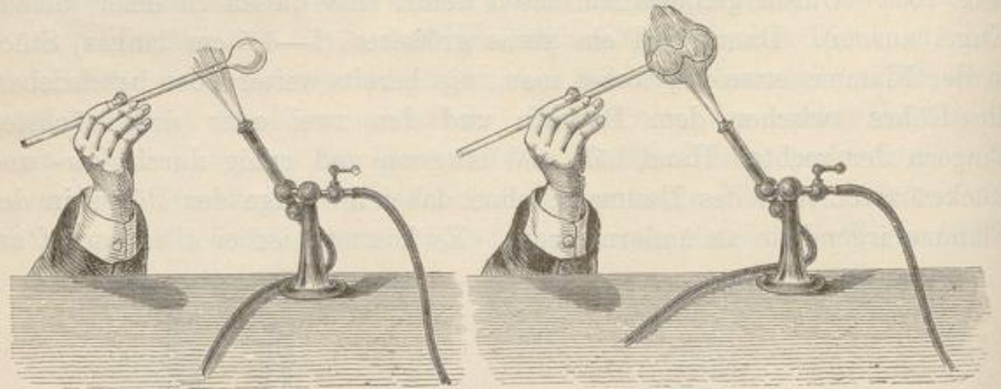
Fig. 138—139. Kugelblasen II und III.
