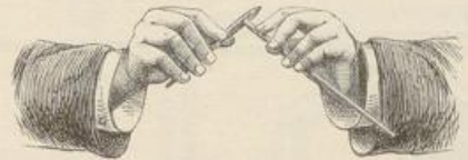
Fig. 131. Erweitern ausgezogener Spitzen.
