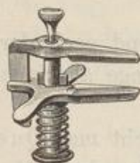
Fig. 336. Quetschhahn nach PROSKAUER.
