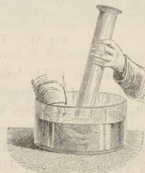
Fig. 521. Absorption von Kohlensäure durch Wasser.
