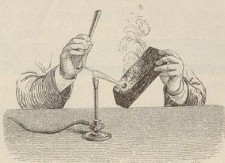
Fig. 539. Verbrennen von Arsen auf Kohle.
