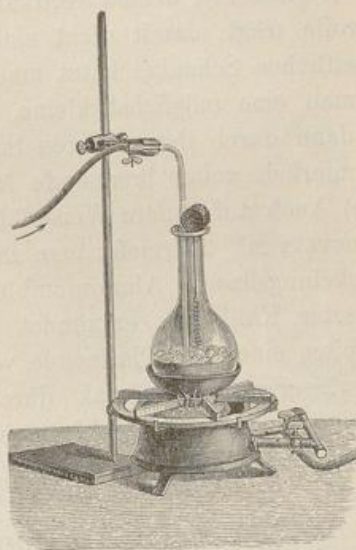
Fig. 851. Explosive Verbrennung von Ammoniak in Sauerstoff.
