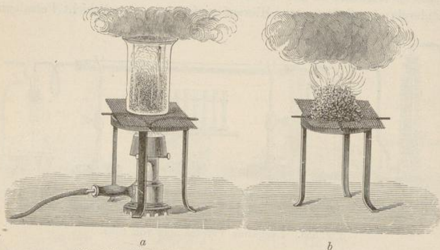
Fig. 554. Verkohlung und Selbstentzündung von Heu.
