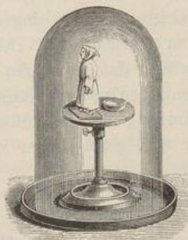
Fig. 673. Wasseranziehung durch Schwefelsäure.
