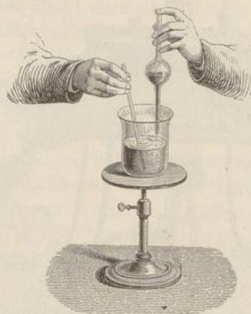
Fig. 680. Neutralisation von Kali durch Schwefelsäure.
