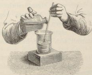
Fig. 672. Mischen von Schwefelsäure mit Wasser.
