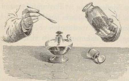
Fig. 804. Oxydation von Alkohol durch Chromsäure.
