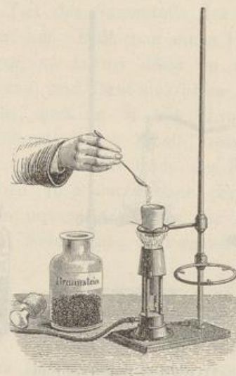
Fig. 808. Oxydation durch Braunstein. Fig. 809. Darstellung der Übermangansäure.
