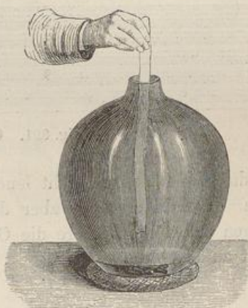
Fig. 820. Darstellung von Ozon durch Phosphor.
