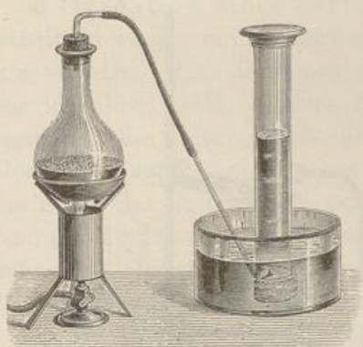
Fig. 814. Entwicklung von Sauerstoff aus Chlorkalk.
