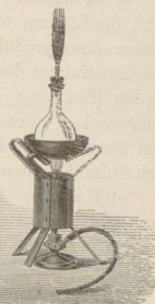
Fig. 543. Verbrennen von Borsäureäther.
