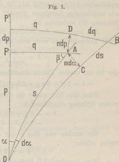
Durch diese Annahmen für die Funktion  $n$  ist die krumme Fläche, auf welcher das Coordinaten-System Fig. 1. liegt, soweit charakterisiert, als für die nachfolgenden geodätischen Aufgaben nötig ist; für die analoge Funktion  $m$  dürfen nicht etwa ebenfalls unabhängige Annahmen gemacht werden, weil  $m$  bereits mit  $n$  durch die erste Gleichung (5) verbunden ist.
