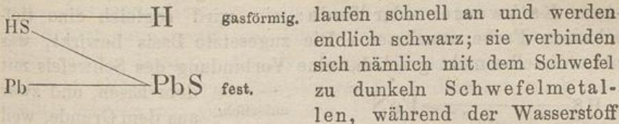
**Metalloxyde und Schwefelwasserstoff.** *Versuch b.* Man schütte in ein Probergläschen eine Messerspitze voll Bleiglätte, in ein anderes etwas geglühten Eisenrost und giesse Schwefelwasserstoffwasser darauf: die gelbe Bleiglätte (Bleioxyd) wird sogleich schwarz; es entsteht ein Austausch der Bestand-
