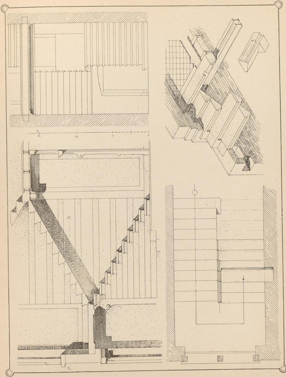
Stocktreppe; im untern Lauf untermauert, im oberen freitragend.
