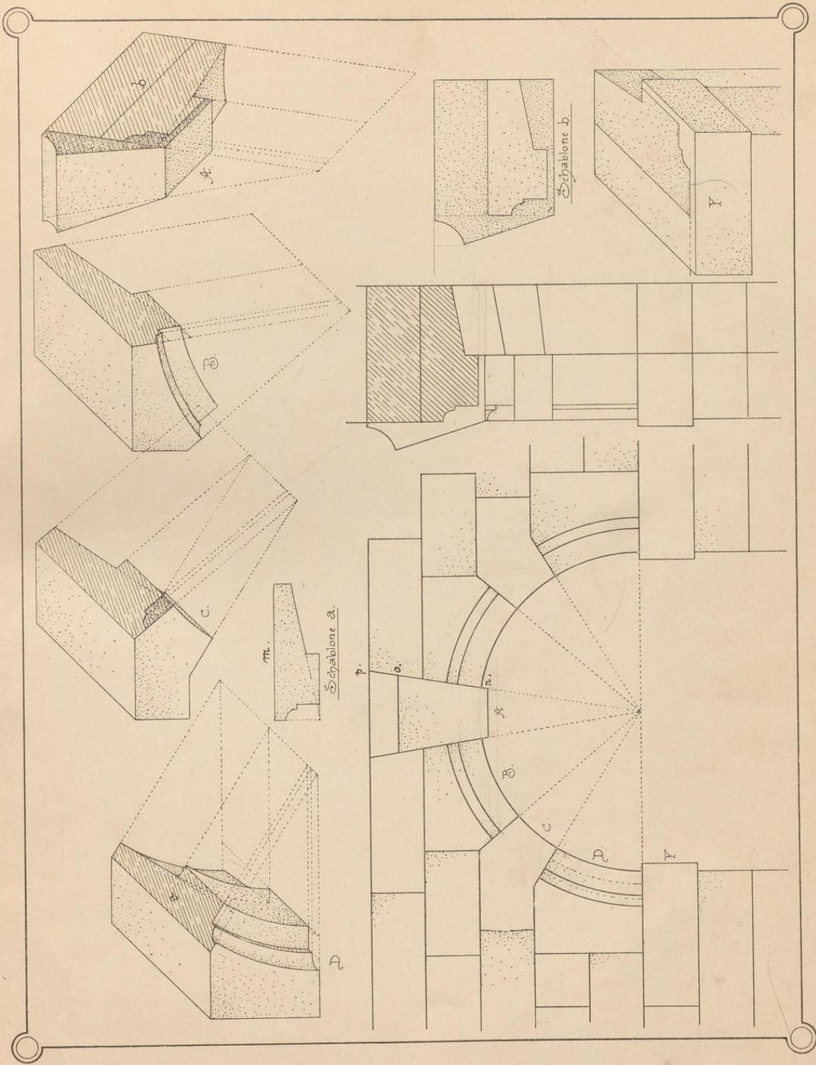
Rundbogen einer Thüre oder eines Fensters mit Schlussstein und angearbeiteter Leibung.
