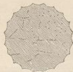
Fig. 103. Durchschnitt der dorischen Säule.
