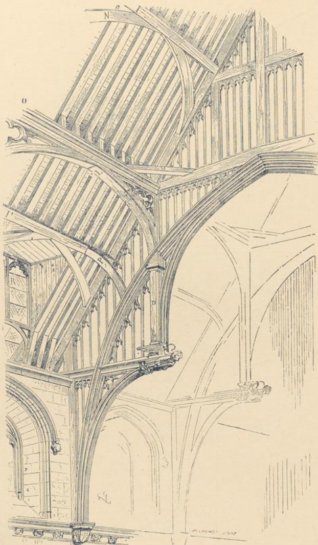
Fig. 438. Dachstuhl der Westminster-Halle in London. Nach Viollet-le-Duc.
