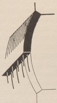
Biegungslinie eines einseitig belasteten Gewölbes und Bewehrung dieses Gewölbes
