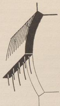
Biegungslinie eines einseitig belasteten Gewölbes und Bewehrung dieses Gewölbes
