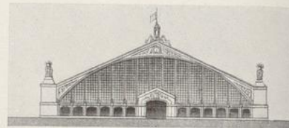
Hector Horeau: Entwurf für die Pariser Hallen. 1849. Schnitt und Aufriß (Glas-Eisen-Bau, Spannweite 86 m)
