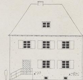
Sichtbarer Sockelabsatz nur 15 cm über Gelände. (S. Musterbl. 5d, 6a u. 6b)
