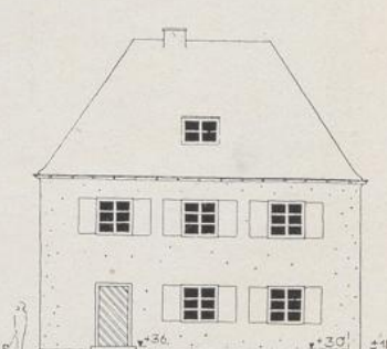
Erdgeschossfussboden nur 30 cm über Gelände (Mindesthöhe n. Allg. Bauordng. § 27)
