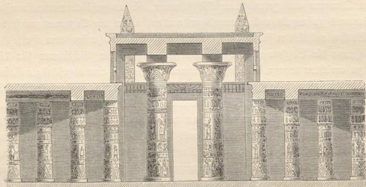
Fig. 22. Amuntemple zu Karnak. Durchschnitt des Säulensaals.
