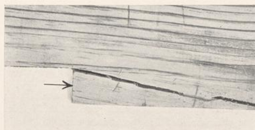
Abb. 15a und b. Fichtenholz nach Überschreiten der Biegefestigkeit. Abb. 15a zeigt geradfaseriges Fichtenholz mit der Biegefestigkeit K_b = 800 \text{ kg/cm}^2 bei 10 v. H. Feuchtigkeit, Abb. 15b astiges Fichtenholz mit K_b = 286 \text{ kg/cm}^2 bei 10 v. H. Feuchtigkeit.
