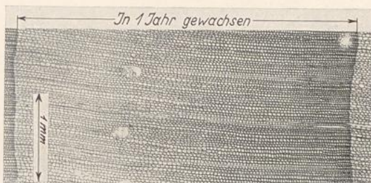
Abb. 4. Querschnitt durch Kiefernholz mit allmählichem Übergang vom Frühholz zum Spätholz, mit mittlerer Festigkeit (Zugfestigkeit 773 \text{ kg/cm}^2 ). Gewicht 0,65 \text{ kg/dm}^3 bei 23 v. H. Feuchtigkeit.
