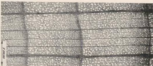
Abb. 6. Querschnitt durch Rotbuchenholz mit viel Spätholz und hoher Festigkeit (Druckfestigkeit rund 930 \text{ kg/cm}^2 ). Gewicht 0,70 \text{ kg/dm}^3 bei 10 v. H. Feuchtigkeit.
