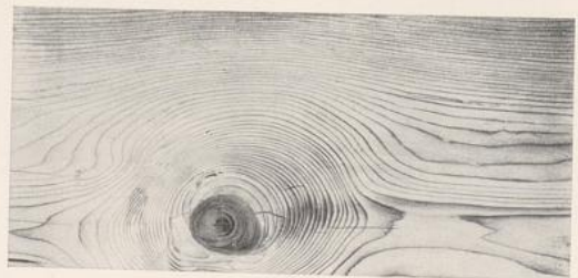
Abb. 10. Ast in der Zugzone eines Balkens aus Fichtenholz. Die den Ast umhüllenden Fasern sind an der untern Balkenfläche angeschnitten.
