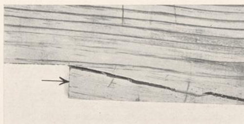
Abb. 15a und b. Fichtenholz nach Überschreiten der Biegefestigkeit. Abb. 15a zeigt geradfaseriges Fichtenholz mit der Biegefestigkeit K_b=800 kg/cm 2 bei 10 v. H. Feuchtigkeit, Abb. 15b astiges Fichtenholz mit K_b=286 kg/cm 2 bei 10 v. H. Feuchtigkeit.
