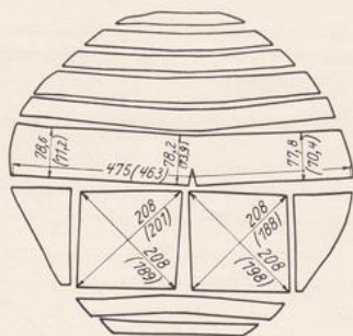
Abb. 17. Formänderung der Querschnitte von Bohlen und Balken aus Buchenholz. Die Zahlen ohne Klammern bedeuten Maße der frisch geschnittenen Hölzer, die Zahlen in Klammern Maße nach 2 1/2 monatiger trockener Lagerung
