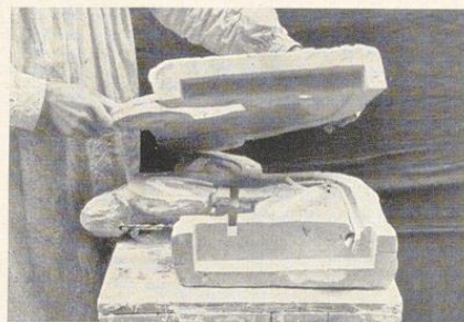
Bild 552. Die Form wird zusammengesetzt, die Füße werden für sich gegossen
