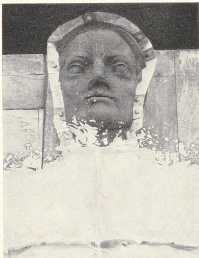
Bild 640. Anfertigen der Formschale für überlebensgroße Figur
