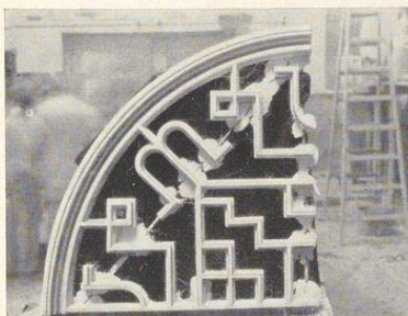
Bild 575. Der erste Gipsguß ist aus der Leimform herausgenommen
