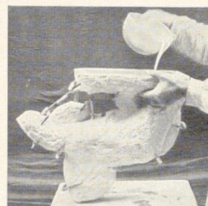
Bild 553. Ausgießen der Form mit flüssigem Gipsmörtel
