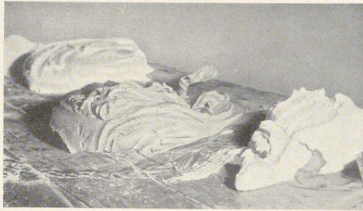
Bild 337. Mörtelmischungen für die Grundtöne des Marmors
