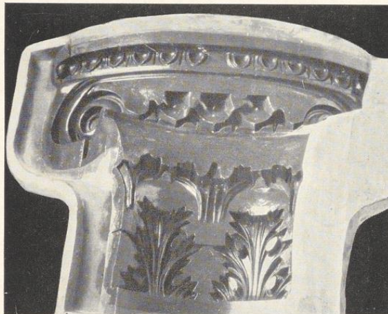
Bild 597. Kombinierte Leimform für ein Kapitell, das linke Gipskeilstück ist bereits abgenommen
