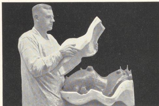
Bild 591. Abnehmen der Vorderschale nach Ausführung des Leimgusses
