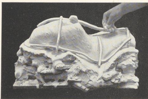
Bild 585. Die in Gips getauchten Verstärkungsseisen für die Formschale werden auf die erste Gipslage aufgelegt
