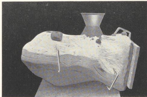
Bild 589. Die beiden Schalen sind mit Klammern verbunden und zur Ausführung des Leimgusses vorbereitet
