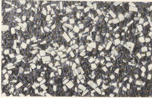
Bild 246-247. Grana-Waschputz, links dunkel, rechts hell
