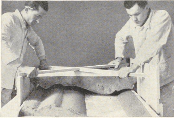
Bild 394. Anlegen des Sandkerns unter Benutzung der Tischschablone
