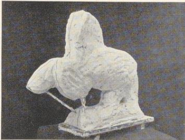
Bild 549. Die fertige Form; die Trennlinie der beiden Schalen ist deutlich sichtbar
