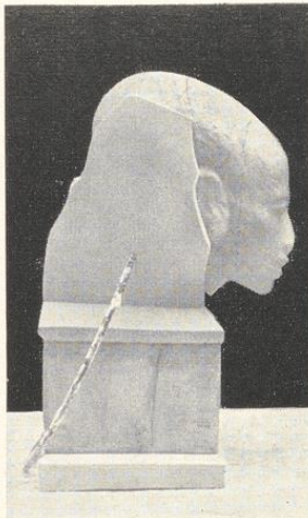
Bild 611. Mittels Rundisenklammer wird das erste Keilstück am Modell festgehalten
