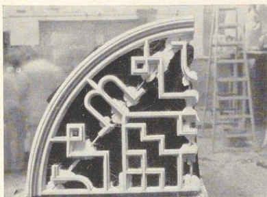
Bild 575. Der erste Gipsguß ist aus der Leimform herausgenommen
