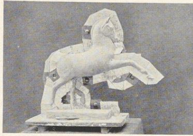
Bild 546. Das Tonmodell ist mit den Blechscheiben abgesteckt
