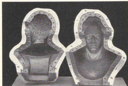
Bild 593. Die beiden Gipsschalen mit dem eingelegten Leimguß
