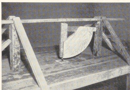
Bild 651. Vorrichtung zum Rundziehen in der Vertiefung
