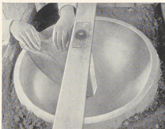
Bild 655. Rundziehen einer Schale über einer Sandschüttung, Einsatzpunkte durchbohrte Metallscheiben (siehe Bild 651)
