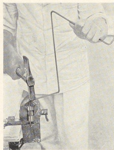
Bild 713. Eckiges Abwinkeln am Schraubstock
