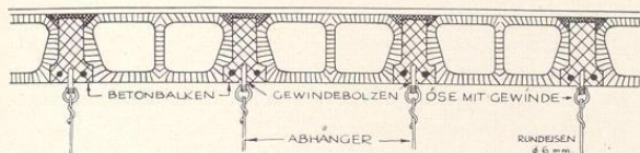
Bild 798. Abhängen einer Rabitzdecke an einer Stahlbetondecke mit Hilfe eingeschossener Aufhängebolzen. Links ein Bolzen mit Öse
