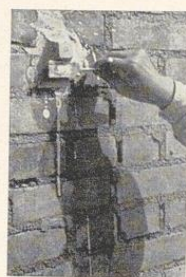
Bild 170. Anlegen des Gipspunktes
