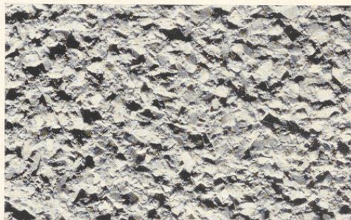
Bild 231. Terranova-K-Rauhputz, körnig (Sondermischung)
