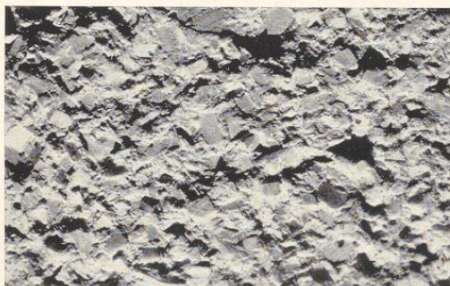
Bild 232. Terranova-K-Rauhputz, extra grobkörnig (Sondermischung)
