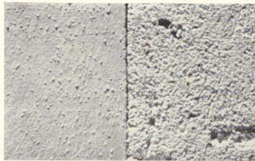
Bild 226. Zweischiehtiger Putz aus Mainsand. 1. Schicht 1 Teil Jurakalk, 4 Teile Mainsand (rechte Bildhälfte). 2. Schicht 1 Teil Jurakalk, 2 1/2 Teile gesiebter Mainsand, gefilzt, mit Kalkmilch mehrmals lasiert
