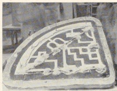
Bild 574. Die Leimform mit Gips ausgegossen, in die Gipsglieder ist Hanf eingelegt. Die aufgelegten Eisen dienen zur vorläufigen Verstärkung
