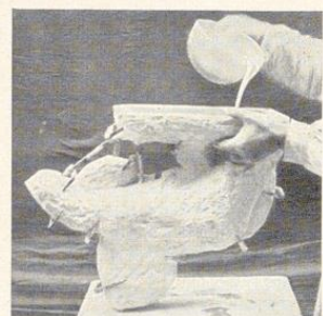
Bild 553. Ausgießen der Form mit flüssigem Gipsmörtel
