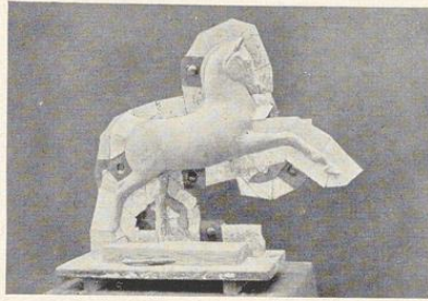
Bild 546. Das Tonmodell ist mit den Blechscheiben abgesteckt
