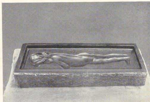
Bild 560. Die fertige Spiegelleimform, die konische Stellung der Umrandung ist deutlich sichtbar
