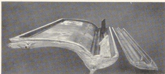
Bild 632. Mit Röhren armierte Stückform für eine große Hohlkehle, rechts liegt ein Keilstück. Die beiden Seitenstücke können ebenfalls abgenommen werden
