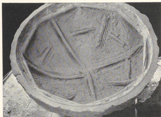
Bild 658. Gießen einer Halbkugel in der Gipsform. Der Guß ist kaschiert und mit Holzlatten versteift
