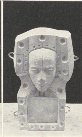
Bild 614. In die Mantel- und Keilstücke werden zur guten Verbindung genügend Marken eingebohrt
