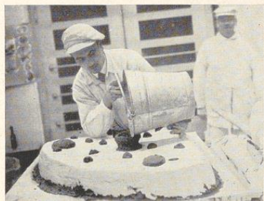
Bild 572. Aufgießen des Leims in die Formschale, die Fugen sind gedichtet, die Tonkugeln zum Schließen der Luftlöcher liegen bereit
