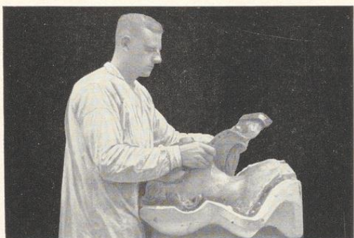
Bild 592. Abnehmen des Leimgusses, er wird dann sofort in die Gipsschale eingelegt
