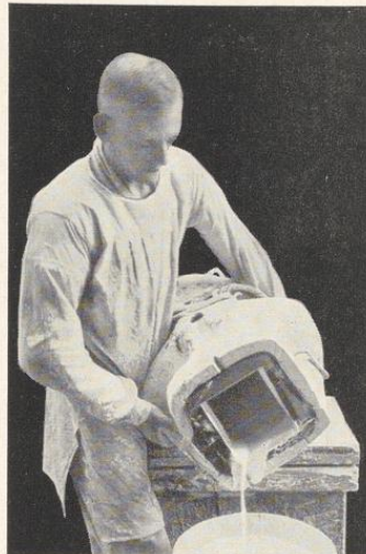
Bild 595. Zur Vermeidung von Luftblasen läßt man beim Hohlguß den überschüssigen Gips wieder auslaufen
