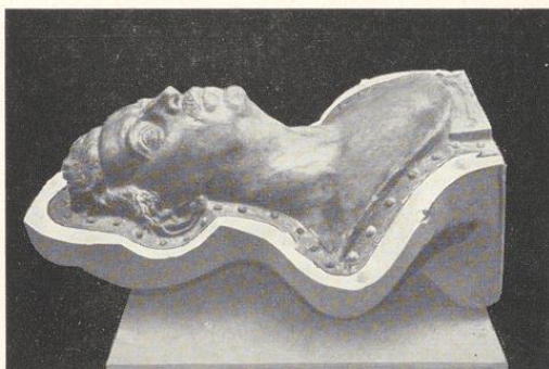
Bild 590. Das Modell mit der Hinterschale und der zugehörigen Leimform fertig für den vorderen Leimaufguß
