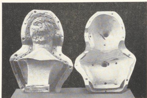
Bild 588. Die fertigen Schalen als Mantel für die eigentliche Leimform
