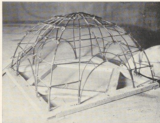
Bild 899. Geschlossenes Klostergewölbe über quadratischem Grundriß mit Stichkappen
