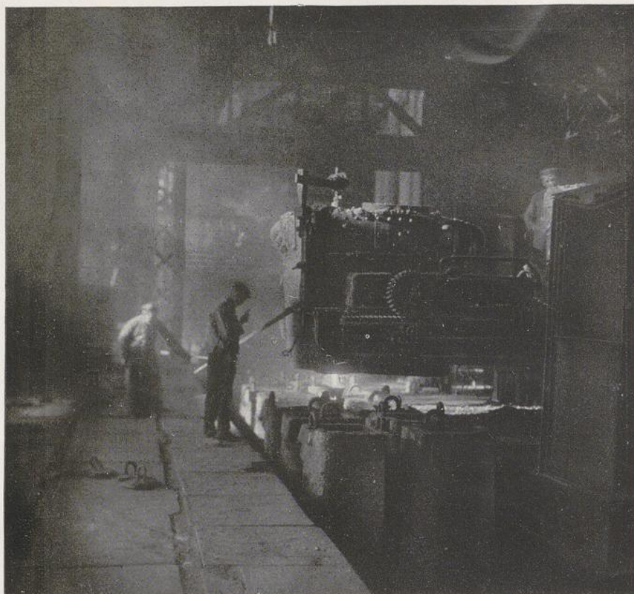
Gießen von Blöcken mit dem Gießwagen im Eisen- und Stahlwerk Phoenix, Hörder Verein für Bergbau und Hüttenbetrieb, Hörde.
