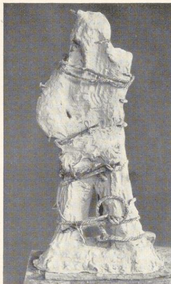
Bild 543. Verlorene Form für den Gipseinguß auf der Polsterbank vorbereitet. Die mit Faden geteilte Form ist geseift, gewässert, mit Stricken gebunden und mit Klammern zusammengehalten. Die Form wird nach Erhärtung des Gusses mit Meißel und Holzhammer abgeschlagen
