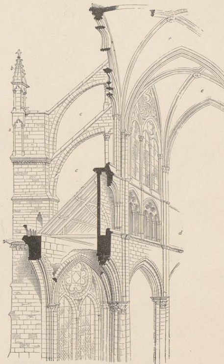
8. Kathedrale zu Amiens. Gewölbesystem aa. Strebepfeiler. b. Fiale. cc. Strebobogen. d. Triforium. ee. Kreuzgewölbe.
