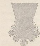
Fig. 214 u. 215. Pfeiler und Pfeilergrundriß im Dom zu Prag.
