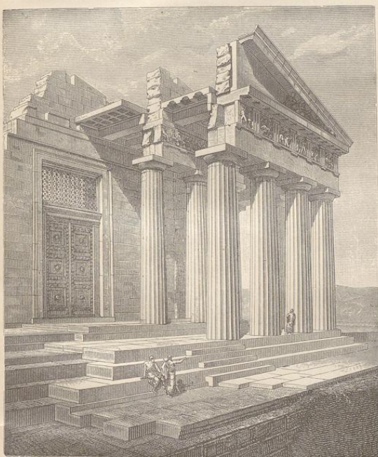
4. Aufbau der Nordostecke des Parthenons. (Nach Niemann.)
