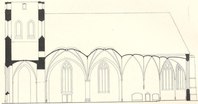
Längenschnitt, 1:400. Nach Aufnahme von Hartmann.
