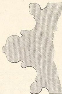
Fig. 41. (Prag. Dom, Profil des Wandpfeilers in Fig. 40.)
