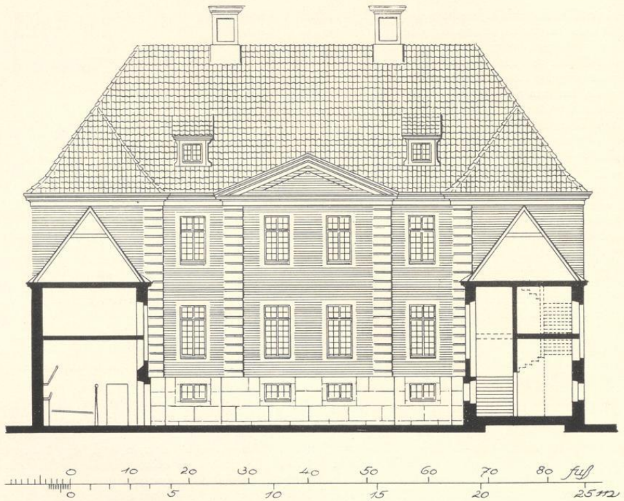
Abb. 359. Entwurf eines Neubaues der ehemaligen Kurie südlich von der S.-Margareten-Kapelle (Domplatz 16/17) Aufriß des Corps de logis mit Hinzufügung der Backsteinfugen und Fenstersprossen Zeichnung eines unbekanntes Baumeisters, Nr. 346; Maßstab 1 : 200. Siehe S. 88
