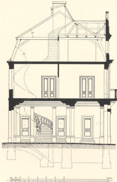
Abb. 329. Querschnitt der ehemaligen Kurie v. Elverveld (Domplatz 3) Zeichnung von W. F. Lipper, Nr. 334; Umzeichnung, Maßstab 1 : 200. Norden rechts
