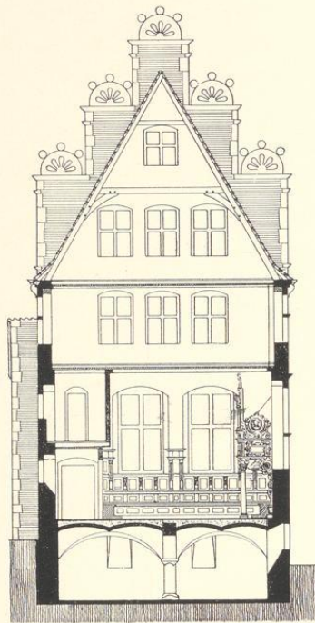
Abb. 826. Querschnitt durch das Steinwerk nach Norden mit der Wandtäfelung und den verkleinerten Fenstern von 1621 Maßstab 1 : 200
