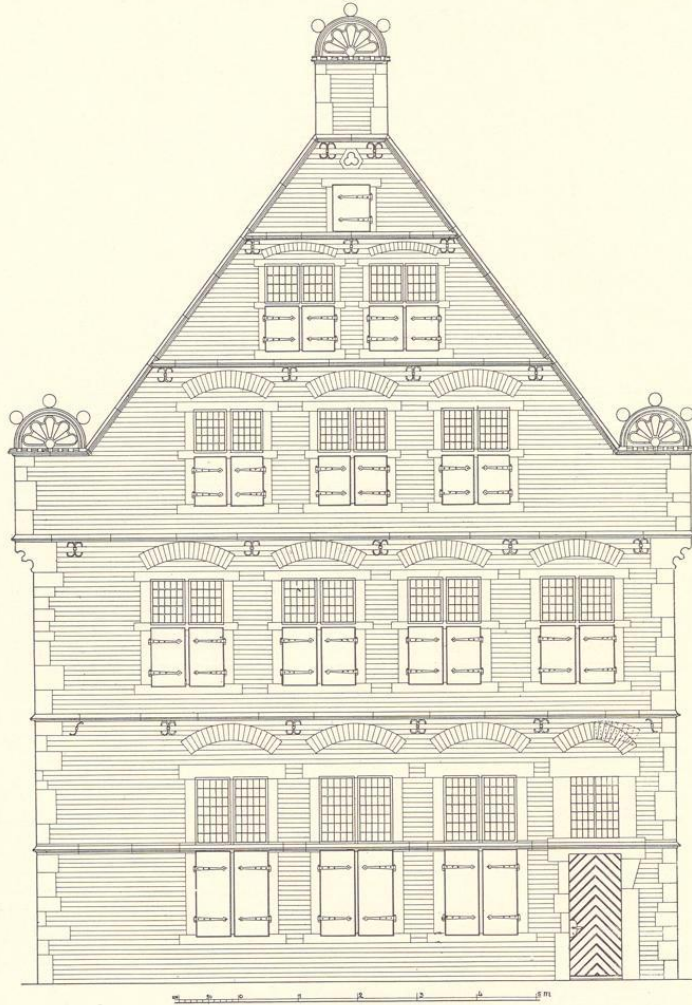
Abb. 758. Rekonstruktion der Rückfront des Hauses Syndikatgasse 6 Maßstab 1 : 100
